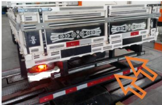
Figura 2 – Para-choque fixado à estrutura da carroceria implementada
