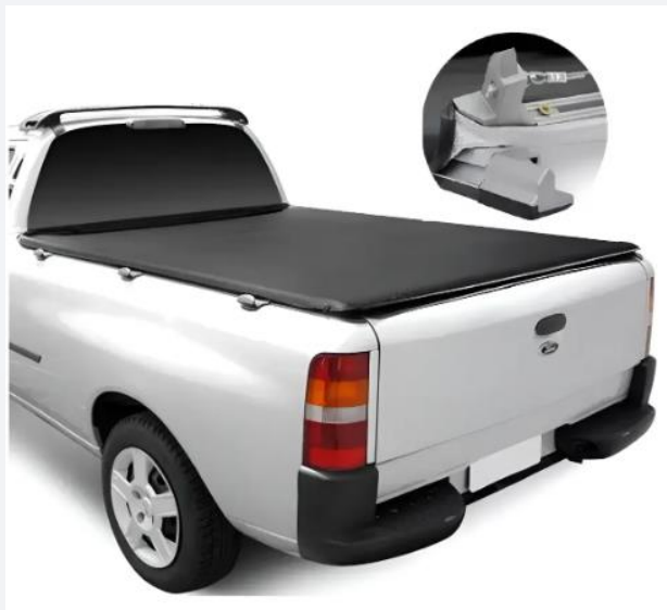
Figura 2 - Exemplo de capota removível. Carroceria aberta.
